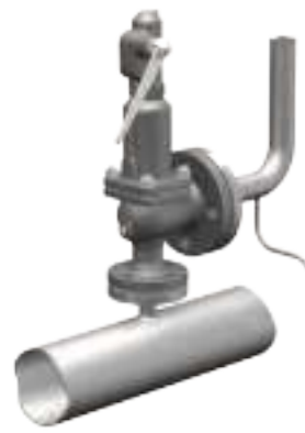
Правильная установка на паропровод
