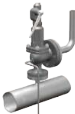
Правильная установка на паропровод
